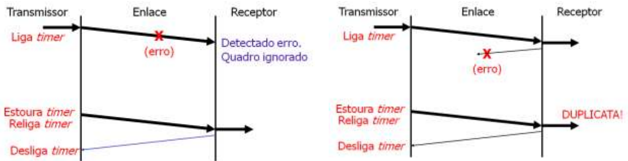
Figura 14 - Protocolo Simplex para um canal com ruído
